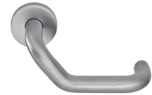
OGRO Türdrücker 8810: speziell für Krankenhäuser konzipiert. Seine nach unten abgewinkelte Form und das zur Tür hin gebogene Griffende ermöglichen die Betätigung auch mit dem Ellenbogen.
