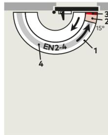
Die **Schließgeschwindigkeit** des TS 72 ist über Ventile in zwei voneinander unabhängigen Bereichen stufenlos einstellbar. Zusätzlich kann der **Endschlag** über das Schließgestänge eingestellt werden. Die **Schließkräfteinstellung** für die jeweilige Türbreite erfolgt beim TS 72 stufenlos über die seitliche Stellschraube.
