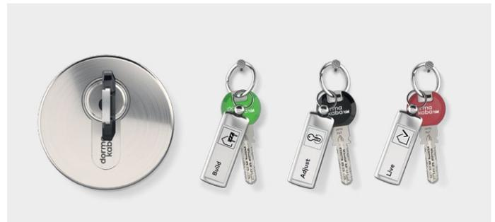
Im Handumdrehen die Zutrittsberechtigung ändern? Möglich durch **3-in-1-Schließzylinder**. Mithilfe des BAZ-Zylinders entziehen Sie die Zutrittsberechtigung verschiedener Schlüssel oder Schlüsselgruppen ganz einfach per Umstellschlüssel. Also egal, ob Sie einer bestimmten Person das Zutrittsrecht entziehen wollen oder einen Schlüssel verloren haben – Sie können flexibel reagieren, ohne den Schließzylinder auszutauschen.
